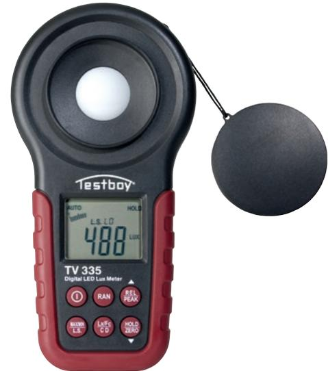
Für die Messung der Lichtstärke von LED-Beleuchtungen ist das Lichtmessgerät Testboy TV 335 bestens geeignet. Das digitale Luxmeter ist handlich und stabil und hat einen großen Messbereich bis 400.000 Lux. Die kunstlichtempfindliche Fotodiode mit einstellbarer Farbtemperatur ermittelt sämtliche Leuchtmittel. Das große LC-Display garantiert ein schnelles und sicheres Ablesen des Messergebnisses.
