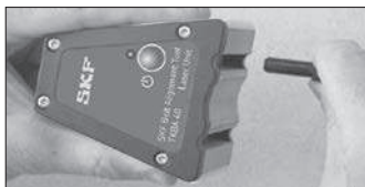
Figura 2 Como encaixar ou remover as guias em V
