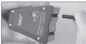
Fig 2 Ajustement ou retrait des guides V
