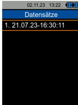
Wählen Sie nun den Datensatz mit den Tasten ▲/▼ aus und bestätigen Sie die Auswahl mit der Taste OK. Die Dateinformationen werden nun wie folgt angezeigt. Drücken Sie die *Zurück*-Taste, um zur vorherigen Ansicht zurückzukehren.
