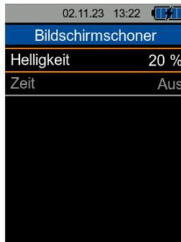
Navigieren Sie mit der Taste ▲ oder ▼ zum Menüpunkt *Helligkeit* und stellen Sie die Displayhelligkeit ein, auf die das Messgerät automatisch gedimmt werden soll. Bestätigen Sie die Auswahl mit der *OK*-Taste. Die aktuell eingestellte Helligkeit ist nun orange hinterlegt. Mit den Tasten ▲ oder ▼ können Sie nun die Helligkeit im Bereich von 20 ... 60 % in 10 %-Schritten verändern. Bestätigen Sie die Einstellung mit der *OK*-Taste.
