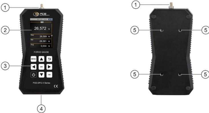
1. Messzelle mit M6-Gewindeanschluss
