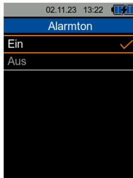
Wählen Sie mit der Taste ▲ oder ▼ die gewünschte Option aus und drücken Sie die *OK*-Taste zum Bestätigen. Sie können nun zum Menü *Alarm* zurückkehren, indem Sie die *Zurück*-Taste drücken.
