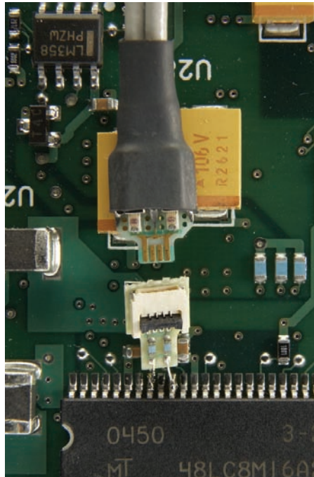
InfiniiMax ZIF tip soldered on board
