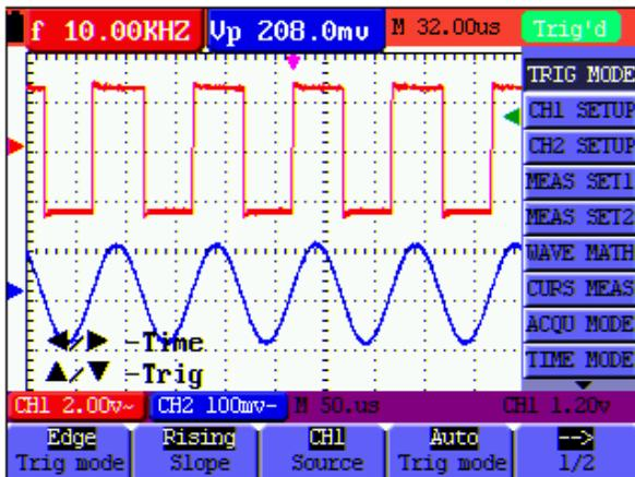
Figure 23: Edge Trigger
