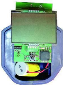
Imm. 45: Remplacement de la pile
