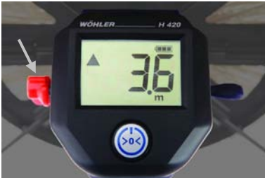
Abb. 8: Sterngriffschraube zum Einstellen der Freilaufbremse
