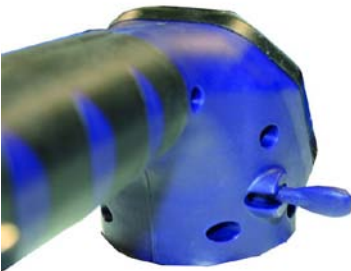
Abb. 2: waagerechte Position des Hebels - Arbeitsposition
