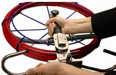
Abb. 9: Montage des Haspelfußes.
