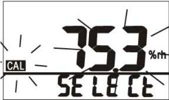
Abb. 28: Kalibrierung des Luftfeuchtigkeitssensors
