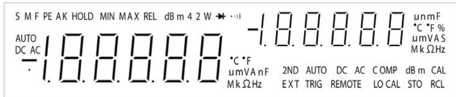
Abbildung 1-1VFD-Vollanzeige , wobei alle Segmente beleuchtet sind
