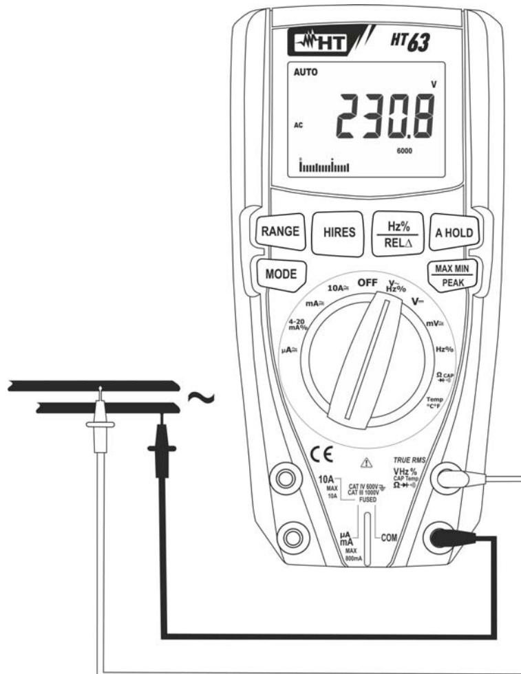
Abb. 3: Verwendung des Gerätes für Wechselspannungsmessung
