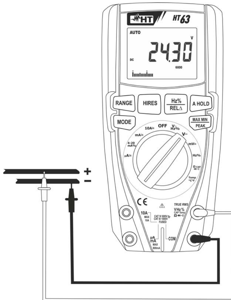
Fig. 2: Mesure de Tension DC
