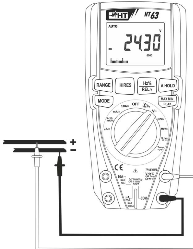
Abb. 2: Verwendung des Gerätes für Gleichspannungsmessung
